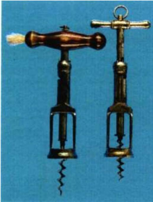
Praktikabilität in höheren Stückzahlen hergestellt worden. Bei diesem Korkenzieher helfen das Hebelgesetz in Verbindung mit dem Drehmoment bzw. das Prinzip der "Schiefen Ebene", den Korken aus der Flasche zu holen. Heute verweigern die Techniken in dieser Form ihre Dienste, da die Korken ungleich länger sind und sie maschinell mit höherem Druck in die Flaschen gepreßt werden. Der Star unter den deutschen Korkenziehern ist
